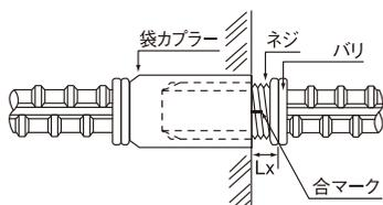
仮締めは、ネジのバリ中心から袋カプラー端部までの距離がLxより短いことを確認し、合マークをネジとコンクリート面に付けて下さい。
