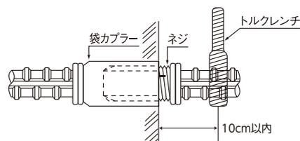
設定トルクをセットしたパイプヘッド付トルクレンチを鉄筋にあてがい「カチッ」と音がするまで締め込み、合マークのずれを確認して下さい。
