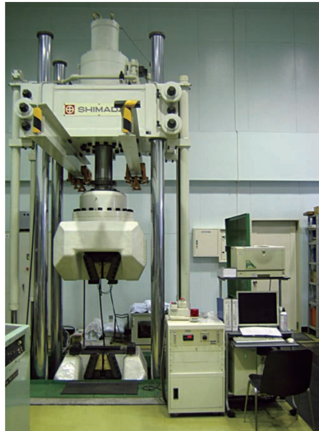
2500kN サーボハイドラリック試験機
