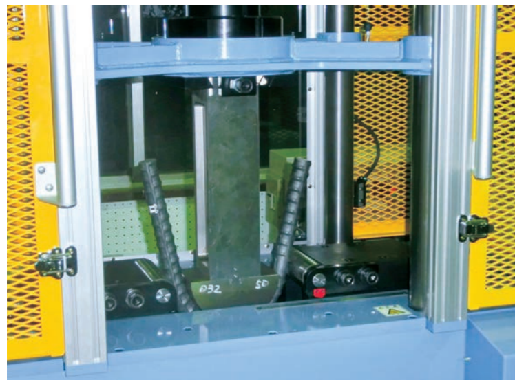
500kN曲げ試験機
